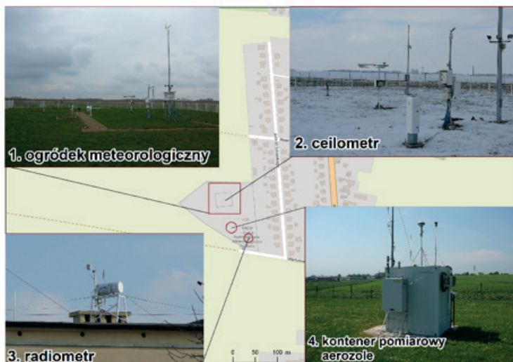
Rys. 5.: Usytuowanie przyrządów pomiarowych na stacji meteorologicznej i stacji badania aerozoli w Raciborzu Studziennej.
